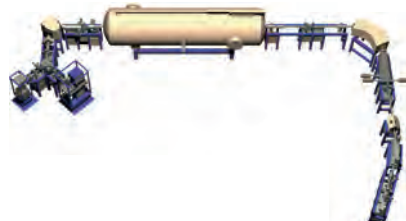
JAEA-AMS-TONO-5MV (ペレトロン年代測定装置)
