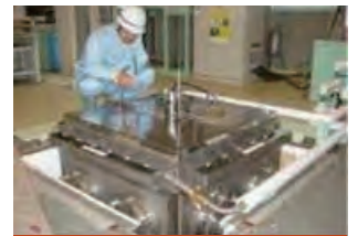
熱-水-応力連成試験設備
